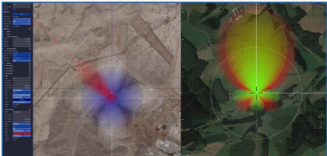
Мощный инструмент настройки устройства постановки помех: секторные, всенаправленные и даже сложные формы луча можно построить или импортировать.
