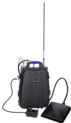
Всенаправленная и направленная антенна, охватывают 5 полос, выходная мощность 120 Вт ( дальность до 2,5 км)
